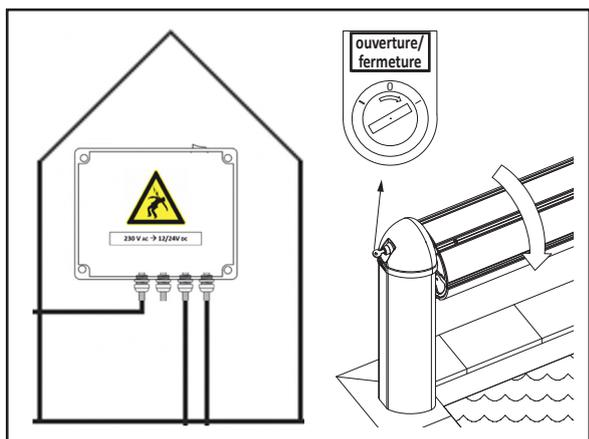
Le pilotage de la couverture se réalise à l'aide d'une commande, verrouillée par une clé ou par un code d'accès, et positionnée à proximité immédiate de la piscine.
